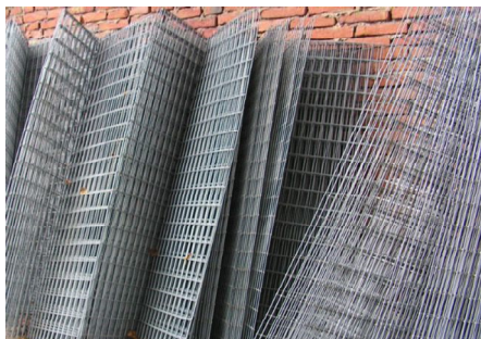
Moduly z gabionových sítí FeZn pr. 4 mm ohnuté do požadovaného úhlu.
